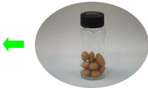
煮豆の腐敗計測 砂糖添加による防腐効果
